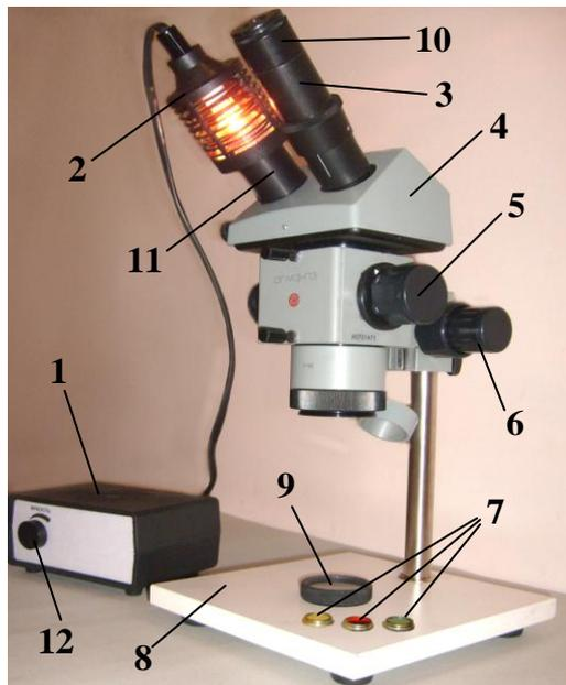
1. Линза с пластиной **9** представляет собой оправу, в которую помещены стеклянная пластинка и соприкасаемая с ней линза с большим радиусом. Устройство предназначено для изучения интерференционной картины "колец Ньютона".
